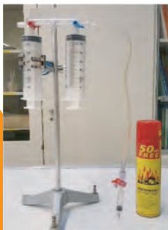
Abb.: Apperatur zur Untersuchung von Butan
